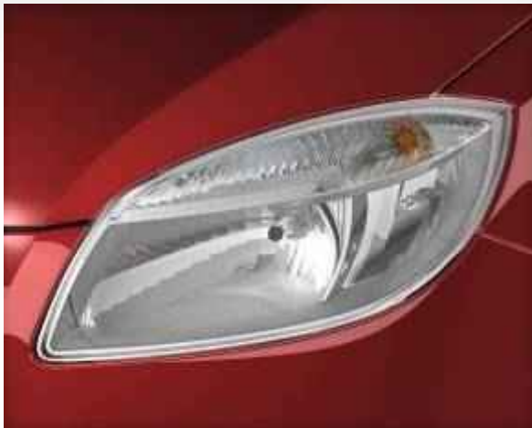
Světlo met reflektorový H4 - jednokomorový (tlumené, dálkové světlo)
